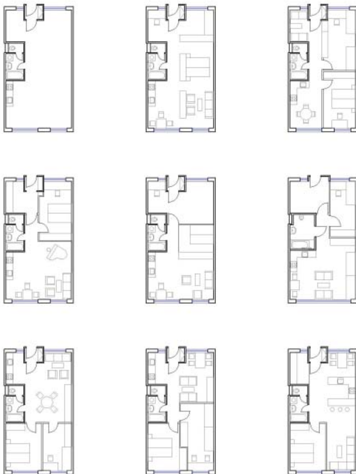
Obr 6. Stehlik, M., Navrkal, M., Dvořák, T., Startovací byty Třeboň, soutěžní návrh, 2. cena. Variabilita základního modulu bytu umožňuje přizpůsobení se potřebám různých nájemníků, ale také úpravy dispozice podle vývoje mladé rodiny, archiv autora
