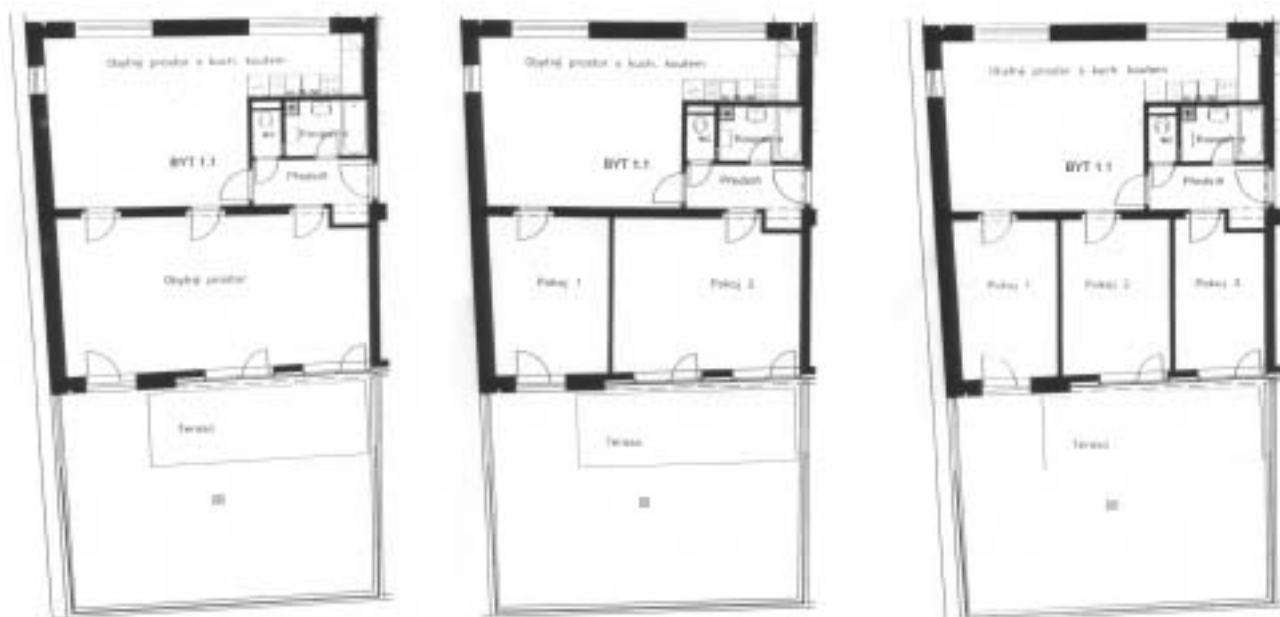
Obr 7. Ukázka základních variant postupného dispozičního členění z katalogu pro největší typ bytu v objektu. archiv autorů
