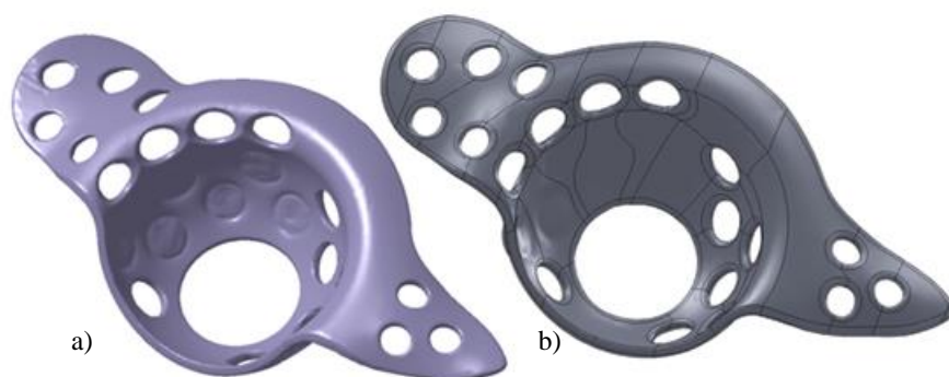
Obrázek 5.3: Model geometrie BS dlahy a) získaný ze skenování, b) s rozdělenými plochami respektující následnou diskretizaci
