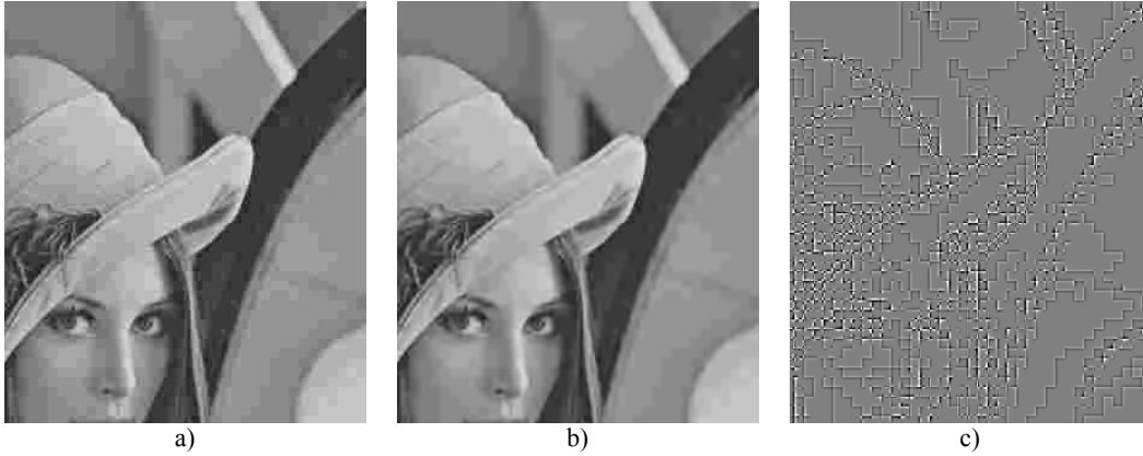
Obr. 6.3: Post-processing obrazu JPEG s komp. poměrem 0,23 b/p (výřez); a) dekomprimovaný JPEG, b) obraz s redukovánými artefakty, c) rozdíl dekomprimovaného a filtrovaného obrazu (rozdíly 10x zvýrazněny).
