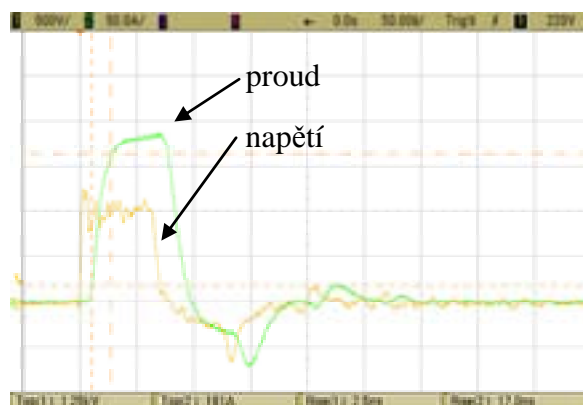
obr. 5.3.6 Průběh napětového a proudového impulsu zdroje s paralelními tvarovacími vedeními a vodní zátěží.
