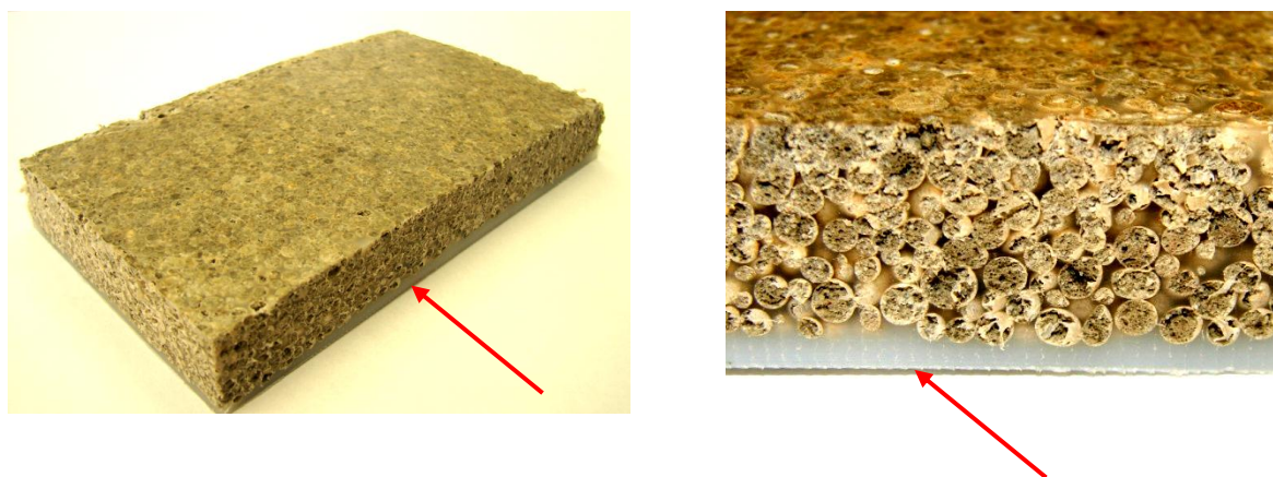
Obr. 12 Prvotní funkční vzorek termopolymerkompozitu s nerovnoměrnou distribucí matrice a částic
