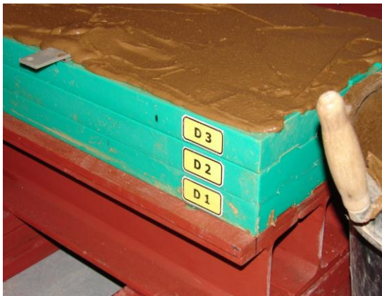
Obr. 20 Souvrství desek D1 – D3 z recyklovaného HDPE spojených na pero a drážku, celkový pohled na zatěžovací rám se zařízením pro monitoring izolačního bloku
