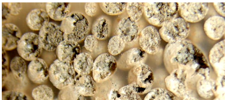
Obr. 13 Povrch termopolymerkompozitu s nedokonalou distribucí a porušením skleněných částic – zvětšeno 3x
