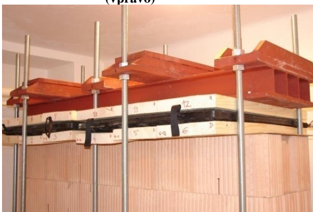
Obr. 23 Sevření zvedacích vaků mezi podložky z dřevěných desek a) celkový pohled b) detail s napojením vaků na hadice
