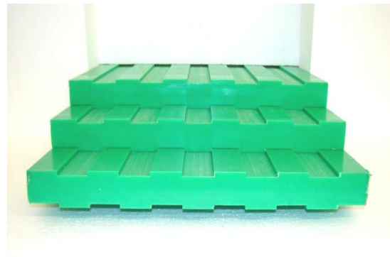
Obr. 19 Desky z recyklovaného HDPE a) souvrství izolačního bloku z desek, b) detail spojení desek na pero a drážku
