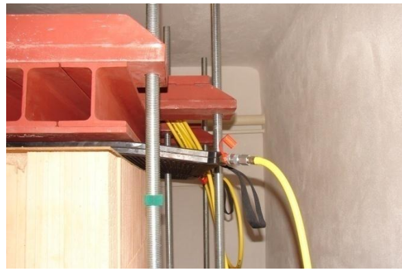
Obr. 21 Horní část zatěžovacího rámu s vysokotlakými vaky ZV 54 a) uzavřená a otevřené převázky, b) podélné nosníky „I“ na zvedacích vacích a sololitu, vaky jsou spojeny hadicemi s vysokotlakou nádobou
