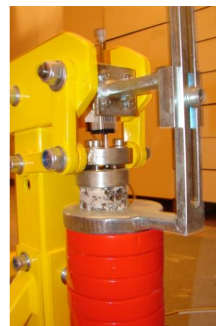
Obr. 17 Axonometrický pohled na zatěžovací stoličci s jednonásobnou pákou a možností volby způsobu zatěžování tah/tlak, detail uspořádání měřicí sestavy, měřený vzorek z kompozitního plastu
