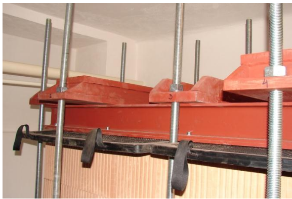
Obr. 21 Horní část zatěžovacího rámu s vysokotlakými vaky ZV 54 a) uzavřená a otevřené převázky, b) podélné nosníky „I“ na zvedacích vacích a sololitu, vaky jsou spojeny hadicemi s vysokotlakou nádobou
