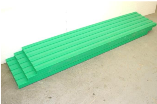
Obr. 19 Desky z recyklovaného HDPE a) souvrství izolačního bloku z desek, b) detail spojení desek na pero a drážku
