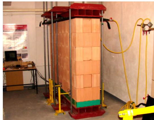
Obr. 20 Souvrství desek D1 – D3 z recyklovaného HDPE spojených na pero a drážku, celkový pohled na zatěžovací rám se zařízením pro monitoring izolačního bloku
