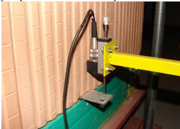
Obr. 22 Snímač dráhy – č. 2, typ FWA 025 TR, osazen na horním líci desky D3 izolačního bloku – detail (vlevo), monitoring deformace v příčném směru – monitorovací body č. M5, M6, M7 (vpravo)
