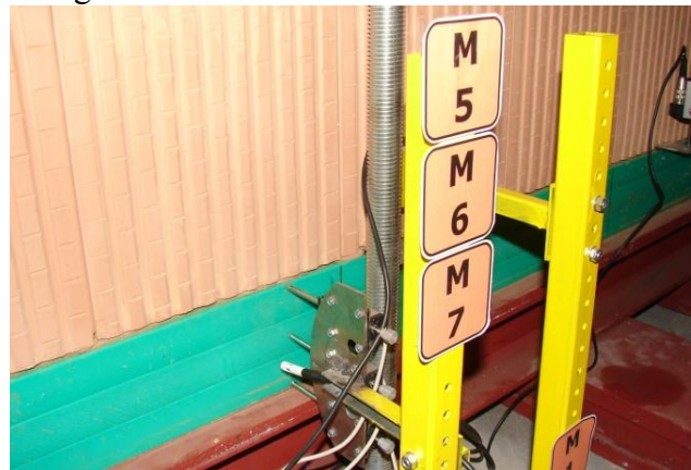
Obr. 22 Snímač dráhy – č. 2, typ FWA 025 TR, osazen na horním líci desky D3 izolačního bloku – detail (vlevo), monitoring deformace v příčném směru – monitorovací body č. M5, M6, M7 (vpravo)
