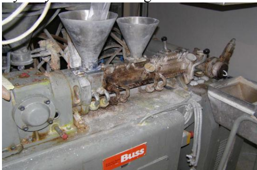
Obr. 9 Kompaundační zařízení Buss MDK46, deska z kompozitního plastu D (dřevěné piliny – recyklovaný PE)
