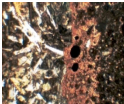
Obr. 4 Vznik kalcitu rekystalizací hydratovaných forem slídkových minerálů na hranici s bazaltem. XN, zvětšeno 50x. Foto M. Gregerová.
