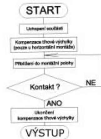
Obr. č. 13: Nástin algoritmu korekce výchylky od tíhového klopného momentu při vertikální montáži
