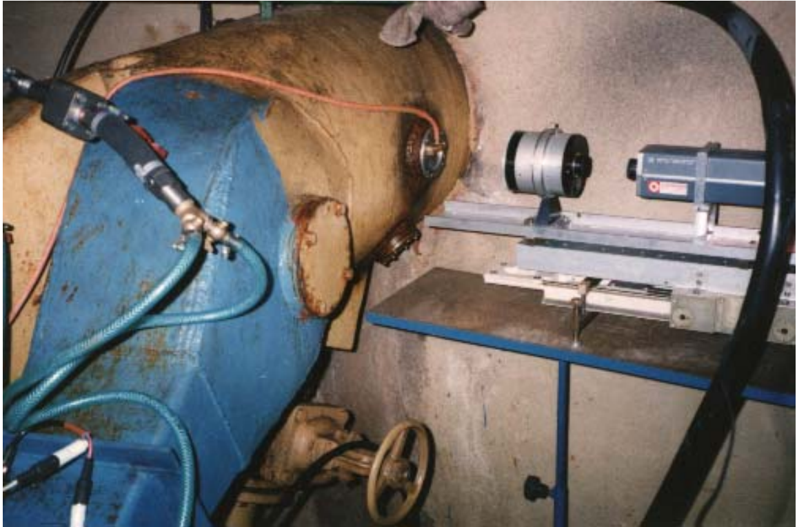
Obr. 17 Měření průtoku vodní turbínou LDA metodou jako součást garančních a účinnostních zkoušek stroje v reálných podmínkách
