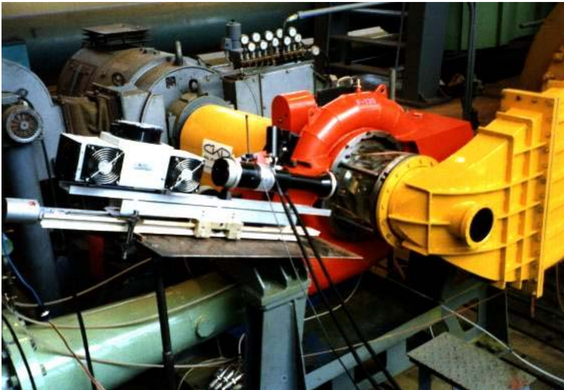
Obr. 18 Traverzační systém k posuvu měrného bodu napříč zájmovým prostorem (LDA systém, měření na zkušebně ČKD Blansko Engineering, a.s.)
