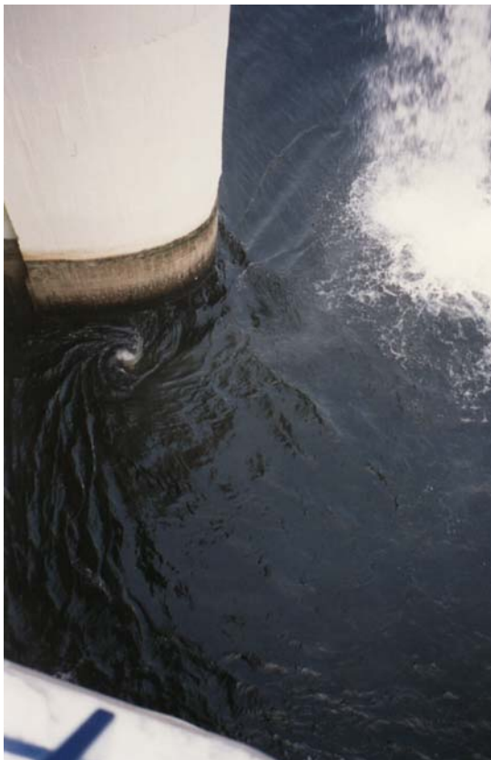
Obr. 12 Vznik vtokových hladinových vírů v předpolí dolního reverzního vtoku PVE Štěchovice – provozní zkoušky
