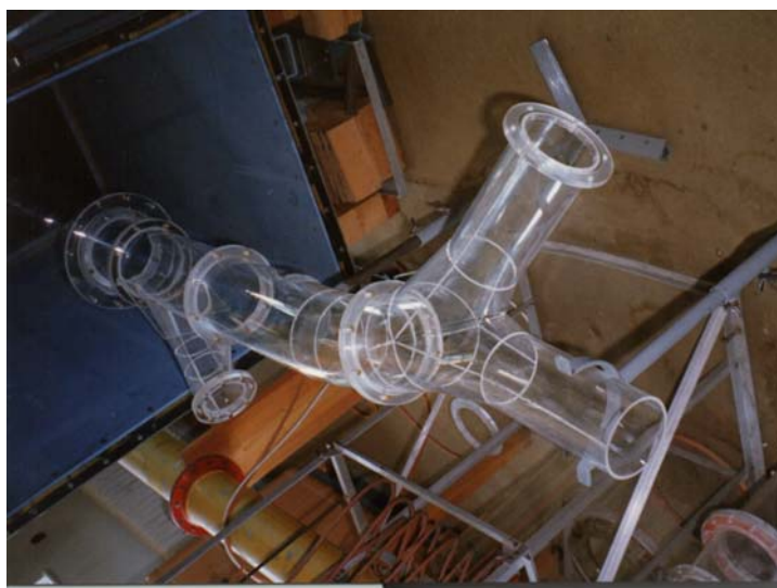
Obr. 10 Výzkum proudových poměrů v systému odbočnic na odtoku z VD Marun v Iránské republice – aerodynamický model
