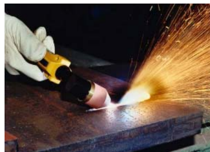
Obr. 16: Plazmové řezání ocelových plátů
