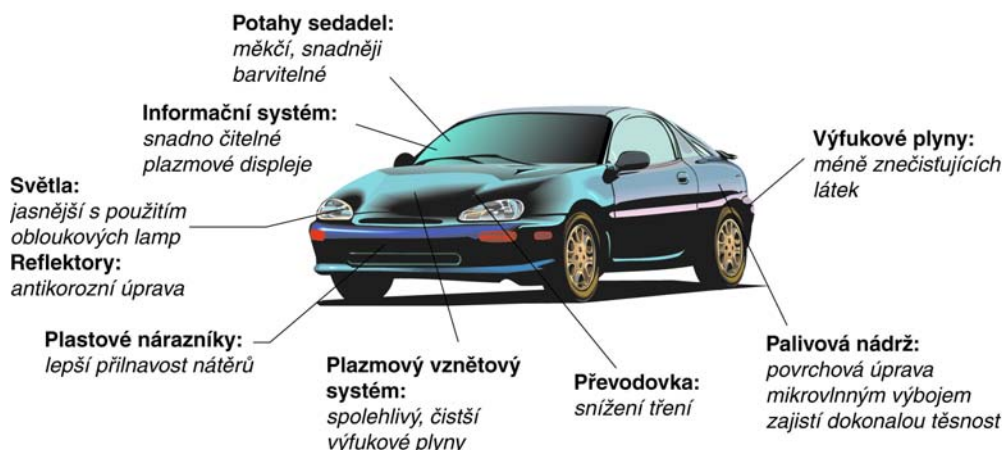
Obr. 12: Ilustrace přímého nebo nepřímého využití plazmatu při výrobě automobilů
