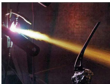
Obr. 15: Umělý kloub při plazmovém nanášení vnější vrstvy
