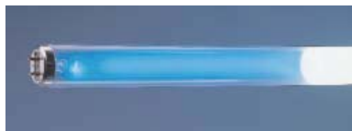
Obr. 7: Plazma v zářivkách generuje ultrafialové světlo, které se konvertuje na viditelné pomocí fosforové vrstvy na vnitřní stěně trubice. Na obrázku je část výbojové trubice zbarvená bílé fosforové vrstvy, takže je patrný modrý doutnavý výboj uvnitř
