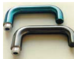
Obr. 14: Dvě kliky s uhlíkovým povrchem nanášeným v plazmatu
