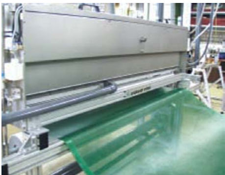
Obr. 13: Zařízení pro zpracování textilu bariérovým výbojem
