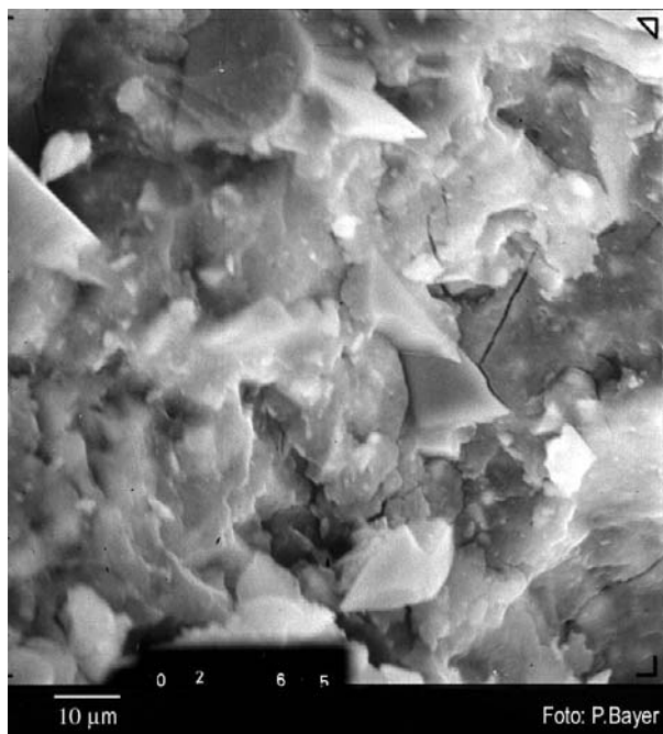
Obr. 4 Mikrostruktura AAAS pojiva (1000x)
