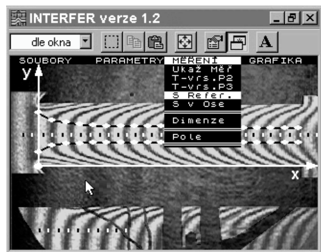
Obr. 13 Vyhodnocování interferogramu teplotního pole v symetricky vyhřívané štěrbině pomocí software Interfer 1.2
