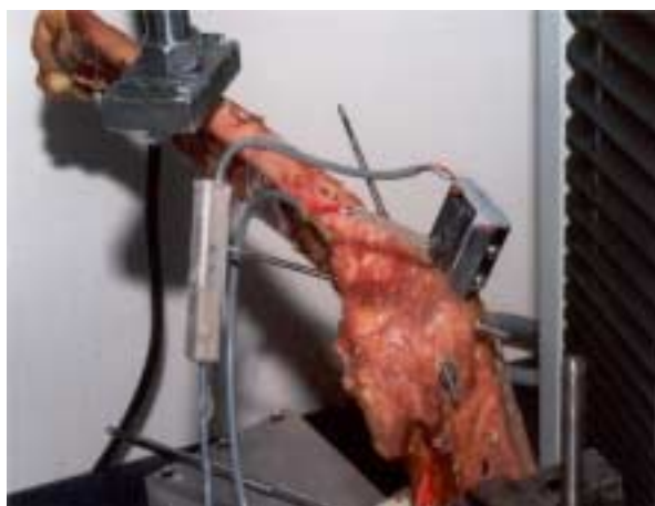
Obr. 12 Detail uložení K-drátů MEDIN® pro fixaci oleokranonu.
