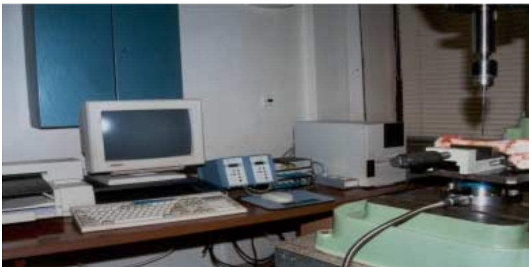
Obr. 2 Nové laboratorní pracoviště s piezoelektrickou měřicí aparaturou KISTLER vybudované v rámci tohoto výzkumu.
