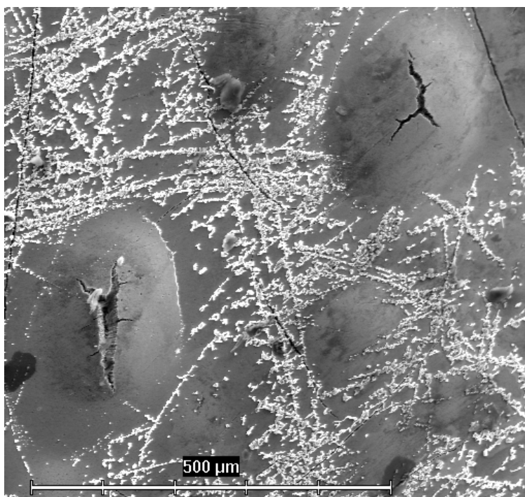
Obr. 5.6 Puchýře Zn povlaku
