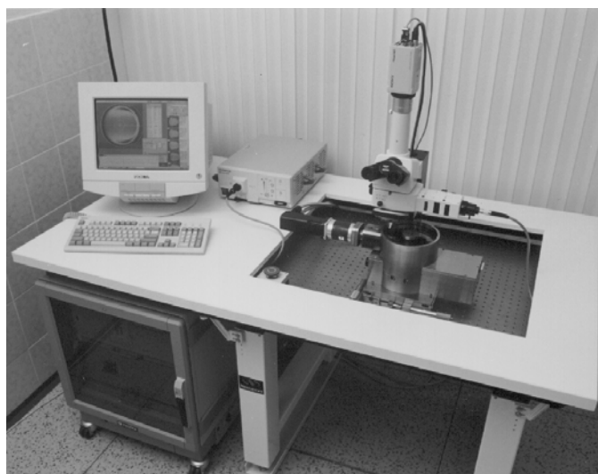
Obr. 15 Měřicí aparatura pro studium tenkých mazacích filmů
