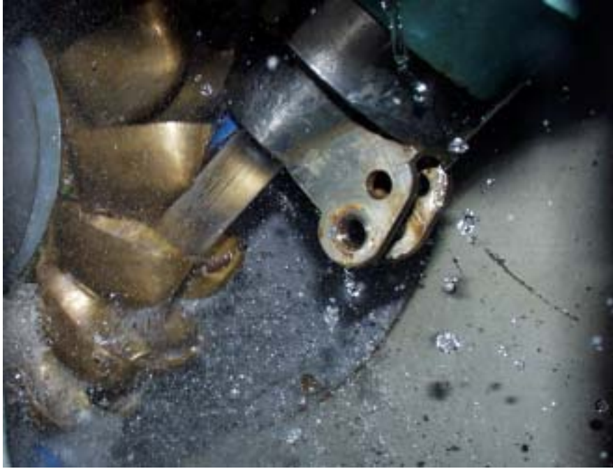
Obr. 16 Vizualizace proudění po korečku – boční pohled z korečků.
