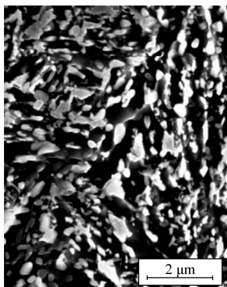
Obr.7 zv.6000x Detail pásma na rozhraní, tvořeného velice jemnými karbidy
