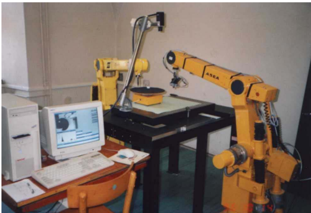
Obr.6.1. Experimentální pracoviště s roboty ASEA IRb6.
