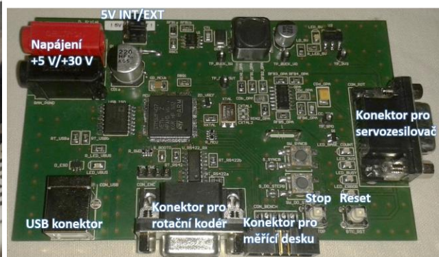
Obr. 2: Vlevo mechanický rotační systém a vpravo realizovaný řídicí modul
