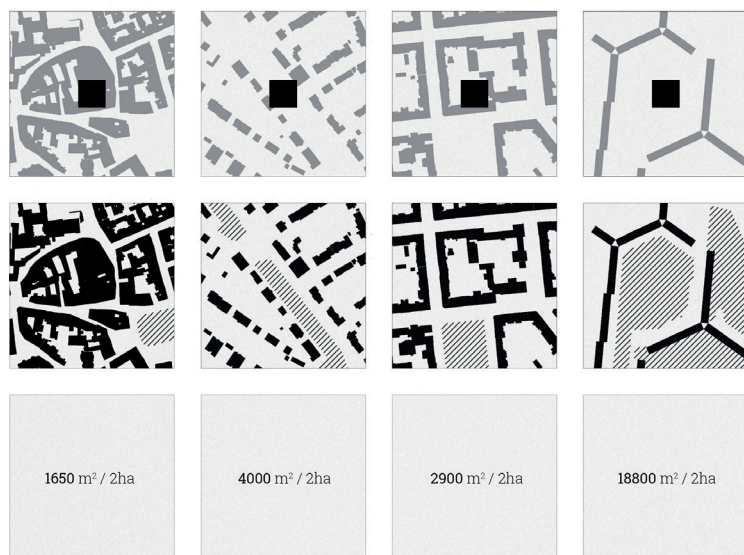
Obr. 2. Porovnání plochy 1 000 m 2 veřejného prostranství / 2 ha v rozdílných urbanistických strukturách města Brna s plochou současného veřejného prostranství / 2 ha, M 1 : 5 000
