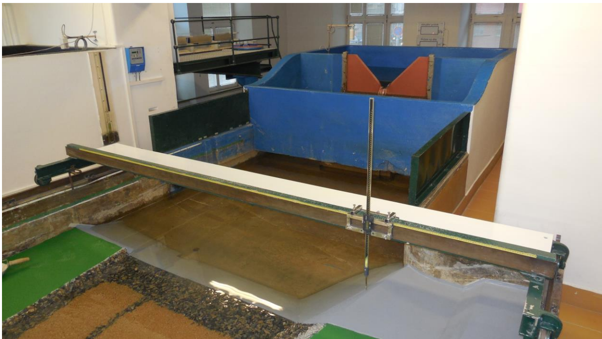
Obr. 58 Pojezd s digitálním hrotovým měřidlem, v pozadí Thomsonův přeliv a ultrazvuková sonda
