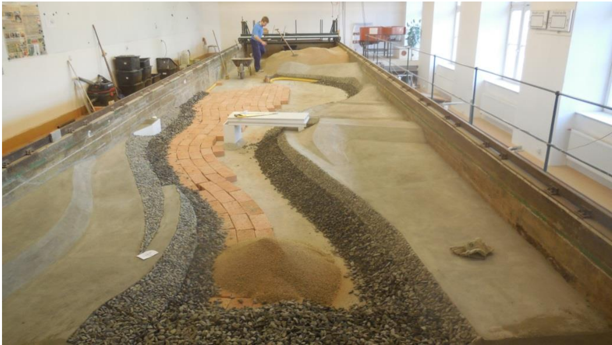
Obr. 54 Připevnění pilířů mostu a vyplnění prostoru levé části modelu cihlami
