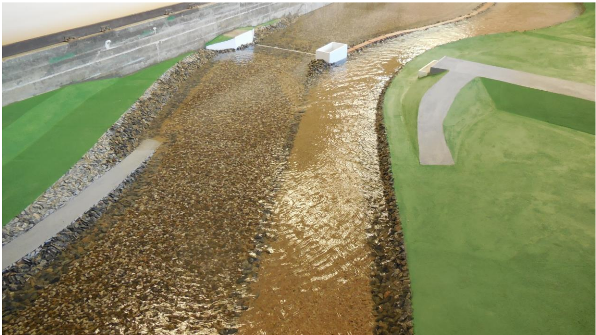
Obr. 70 PV 5 , proudění při kulminačním průtoku
