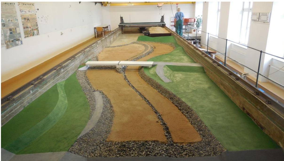
Obr. 56 Doplnění dělicí hráze UPDS a UPP, opevnění kynety, barevné ztvárnění povrchů, urovnání písku a položení mostovek
