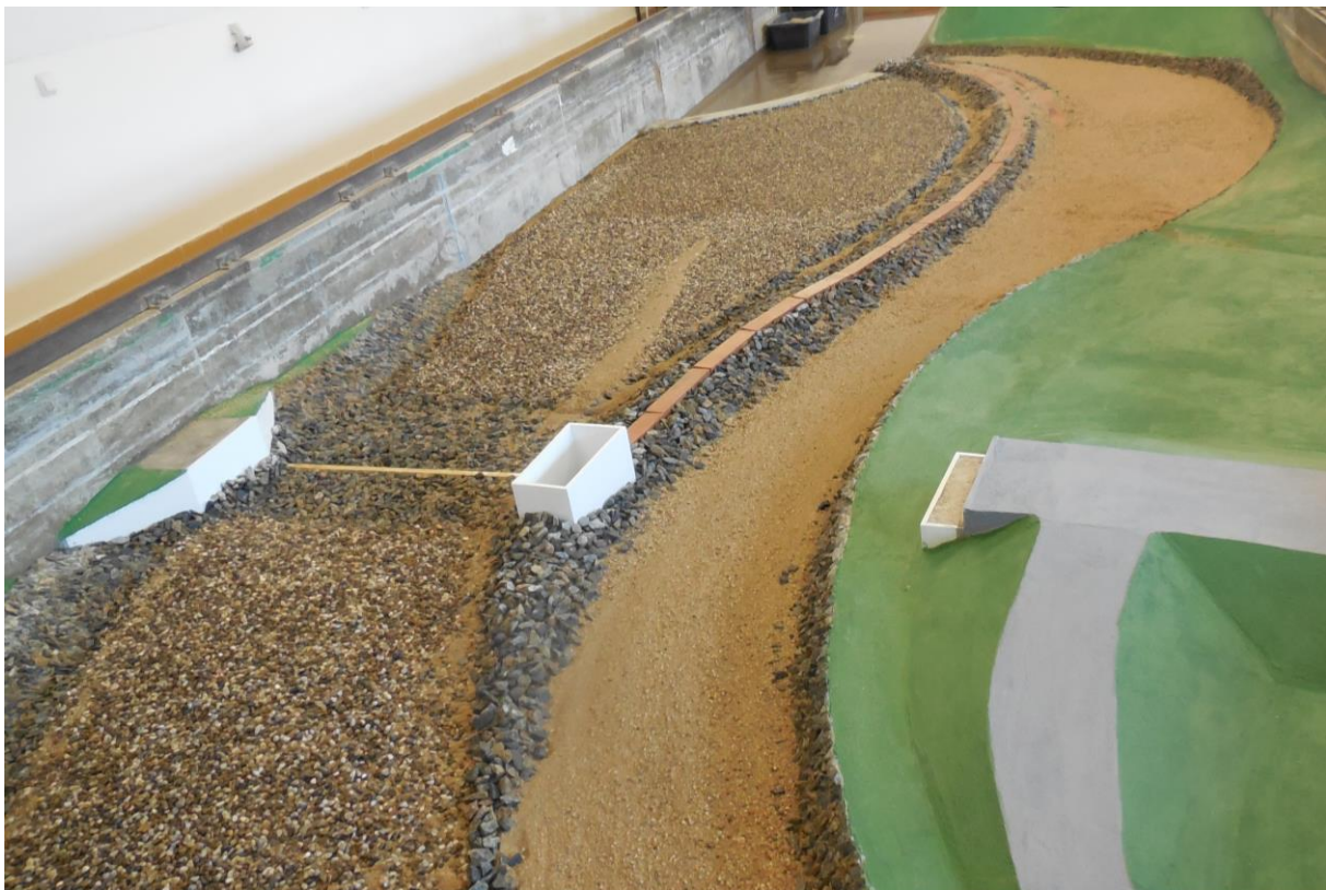
Obr. 66 Opevnění dělicí hráze UPDS a UPP
