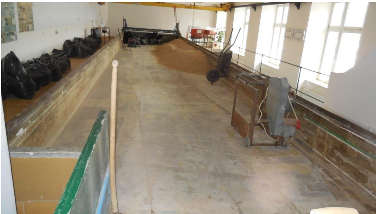
Obr. 50 Příprava žlabu pro umístění modelu, příprava písku
