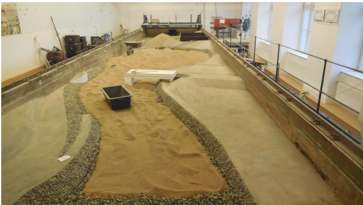
Obr. 55 Zасыпání modelu písekem
