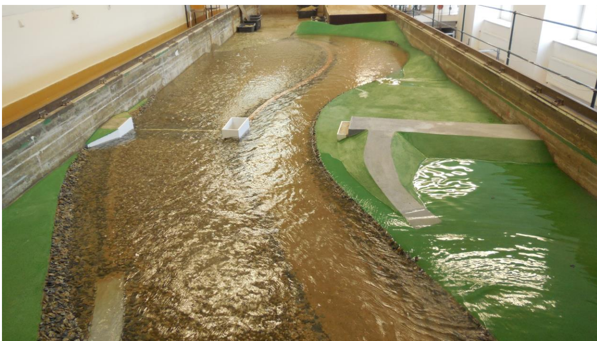
Obr. 94 PV 100 , proudění při kulminačním průtoku
