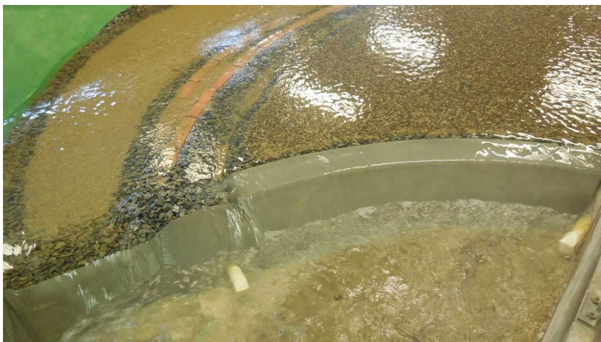
Obr. 61 Úprava přelivu UPP
