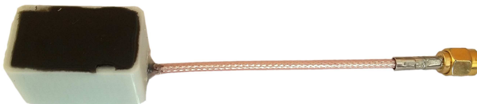
Obr. 3: Měřicí přípravek pro testování zalité antény
