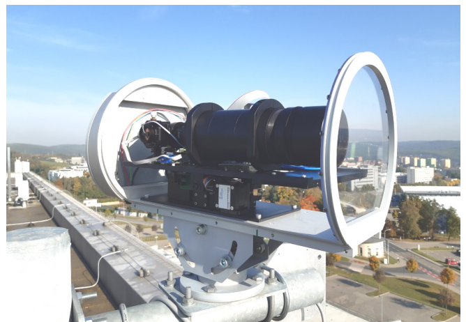
Obr. 1: 3D model a fotografie optické sestavy během testování.
