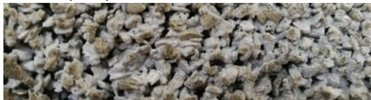
Obrázek 3. Vyroběný vzorek ultralehkého betonu ULC 3 (detail obalení zrn kameniva cementem)
