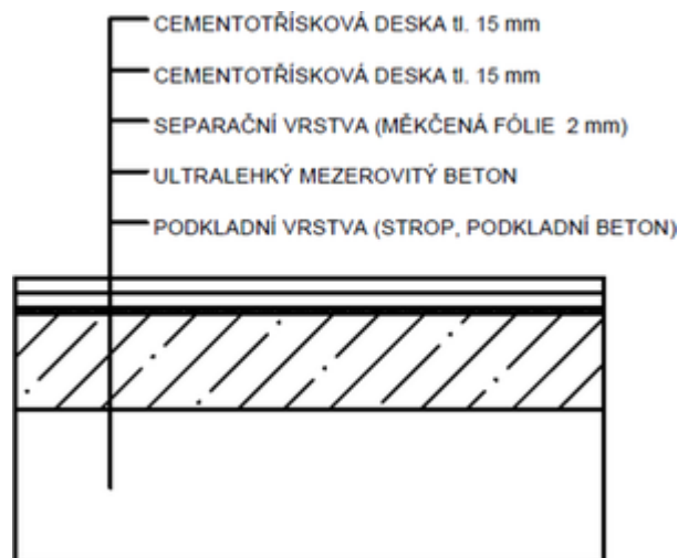
Obrázek 1. Navrhovaná skladba podlahové konstrukce
