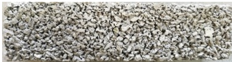
Obrázek 2. Vyroběný vzorek ultralehkého betonu ULC 3
