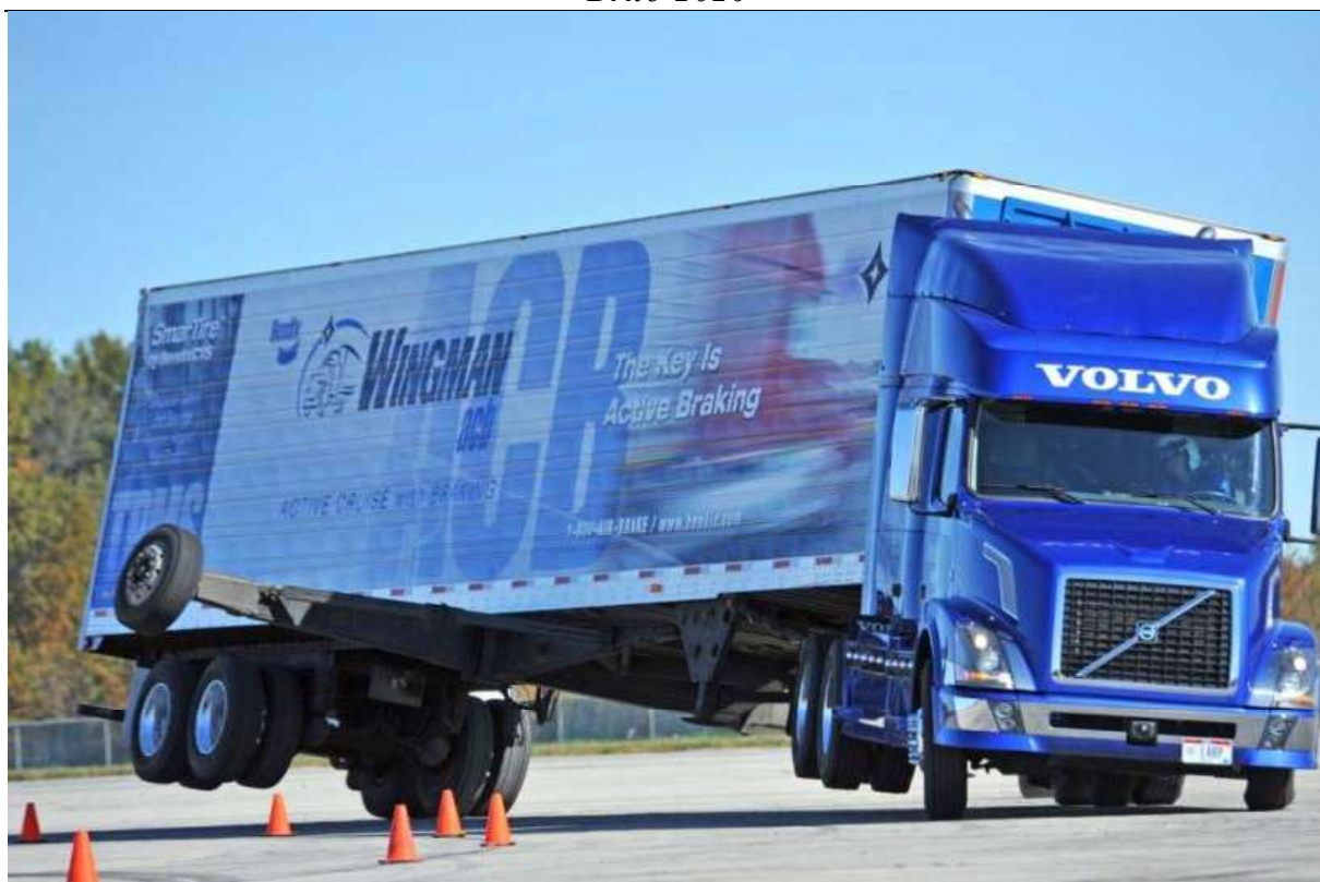
Obr. 8 – Ukázka kolizní situace bez aktivního stabilizačního systému. Fig. 8 – Demonstration of collision situation without active stabilization system.
