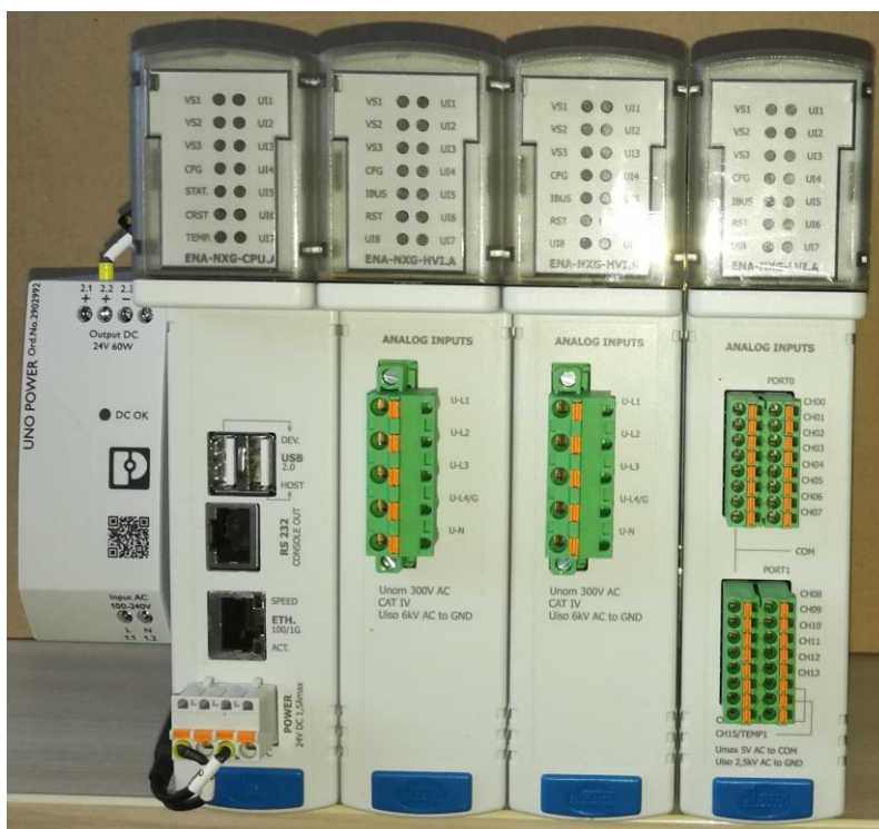
Obr.8: Dva systémy trojfázového měření v provedení ENA-NXG-PQ
