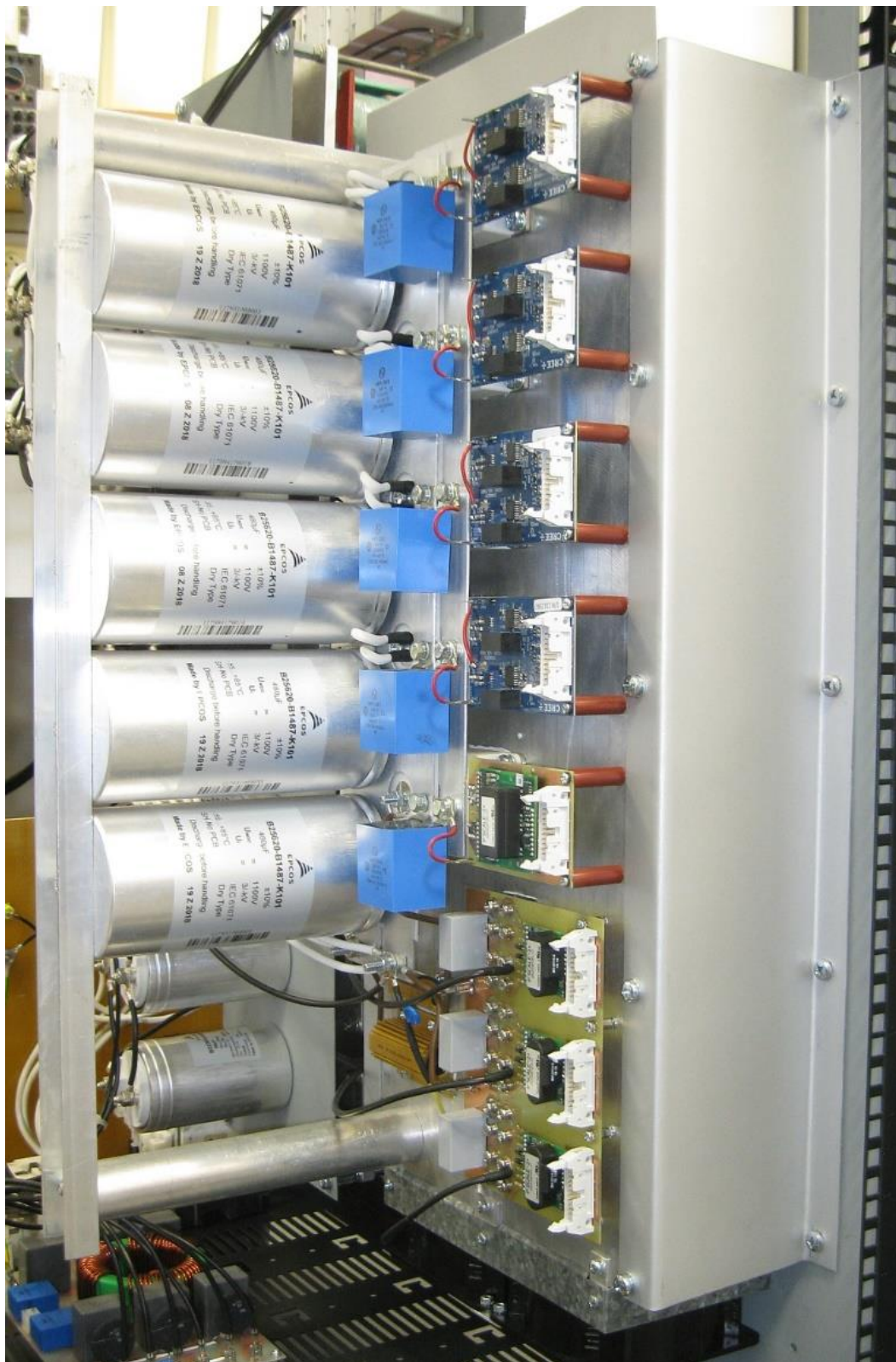
Obr. 20 Měnič aktivního usměrňovače (dole) a výstupního střídače (nahore)
