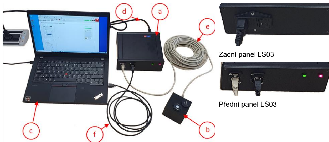
Obr. 7. Sestava přístroje LIGHT SCOPE LS03 se senzorem LM03 a PC a jejich propojení
