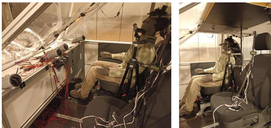
Obr. 3 – Funkční vzorek senzoru při testech v klimatické komoře.
