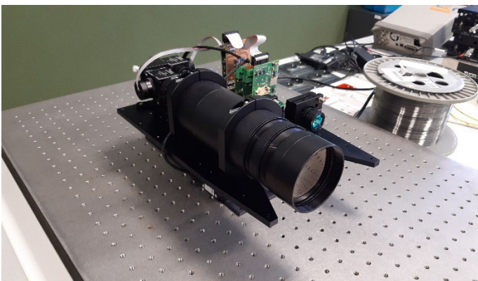
Obr. 1: Fotografie jednotky OBS a stabilizační a vyhodnocovací sestavy pro přenos optické frekvence.
