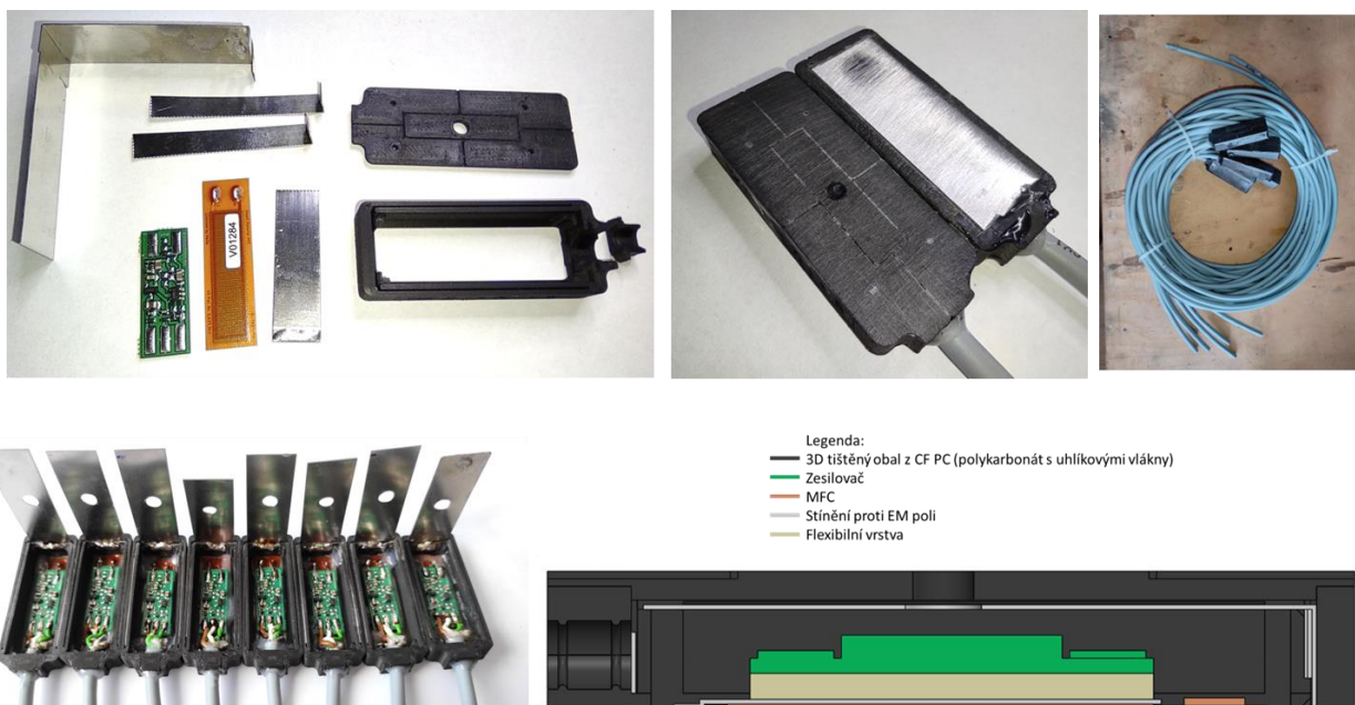
Obr. 1 Konstrukce senzoru založeného na piezokompozitní vrstvě; jeho mechanická, MFC piezoelektrická vrstva, elektronika s operačním zesilovačem, ochranný kryt, kabeláž. Zobrazení sestavení včetně legendy v řezu.
