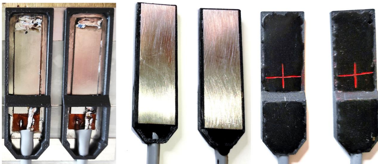
Obr. 2 Integrace mechanické konstrukce železničního senzoru pro snadnou instalaci
