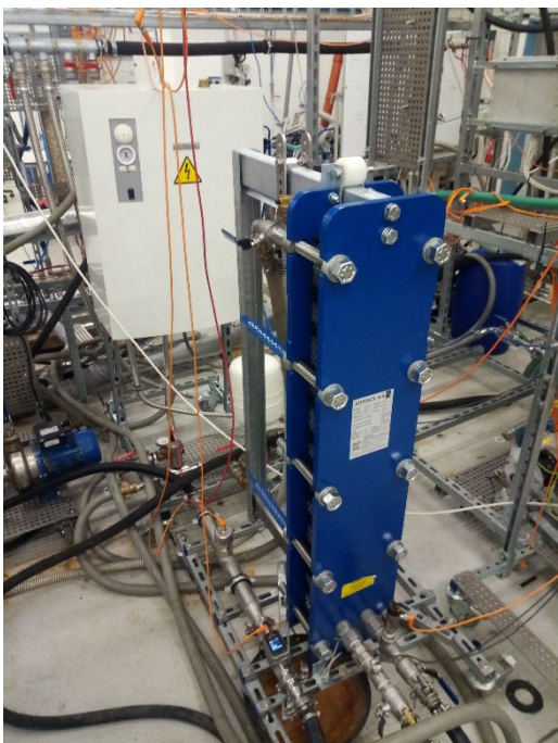
Obr. 4: Dílčí komponenty prototypu: elektrokotel a deskový výměník (vlevo), systém pro měření a regulaci (vpravo)
