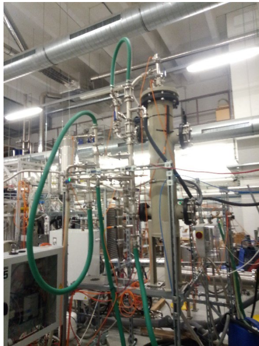
Obr. 3: Přímý kondenzátor v Laboratoři energeticky náročných procesů na VUT v Brně
