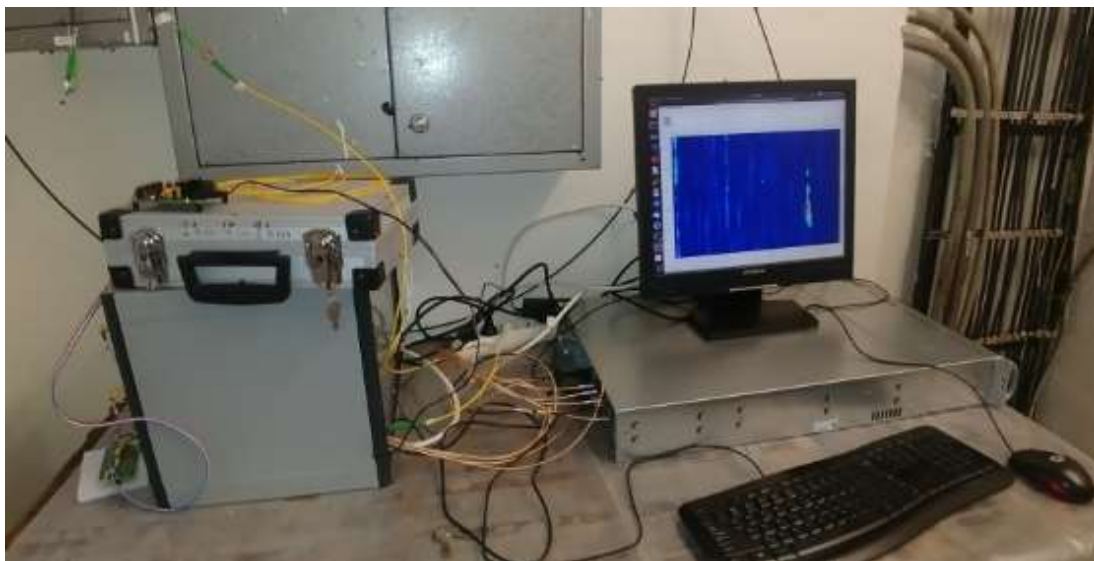
Obr. 5.6: Funkční Měřicí systém napojený na optickou trasu polygonu
