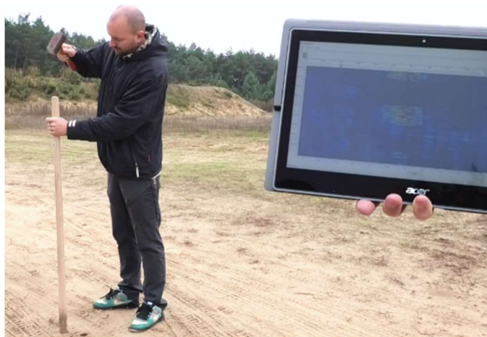
Obr. 5.8: Generování mechanických vibrací a dálkové sledování činnosti sondy
