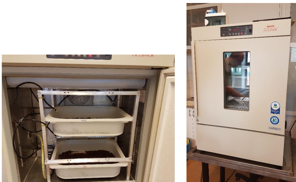
Obr. 8: Osivo v bednách se sítovým dne v inkubátoru v průběhu vlastní inkubace (vlevo), inkubátor s řídicí jednotkou (vpravo)
