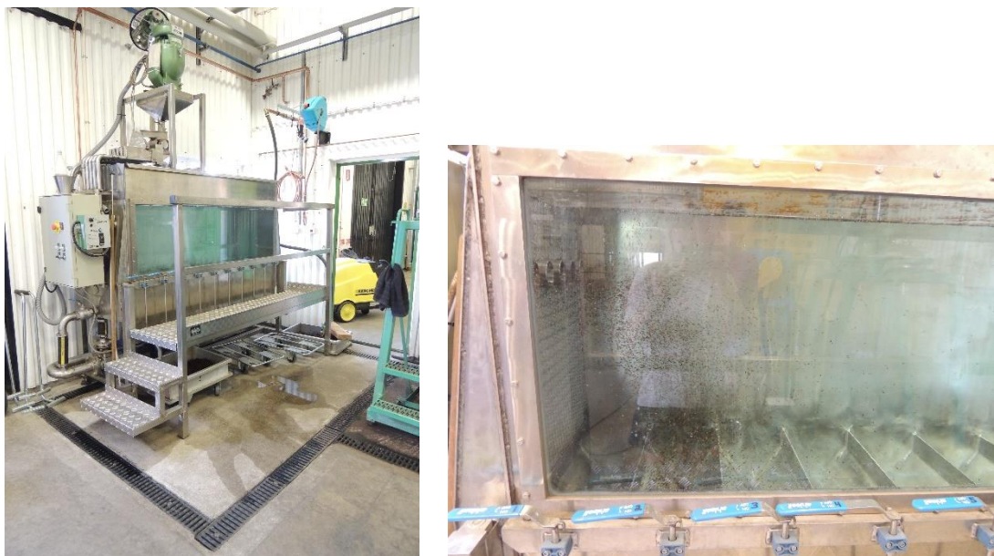
Obr. 6: Plavící komora (vlevo), osivo vstříkované do plavící komory v průběhu separace (vpravo)
