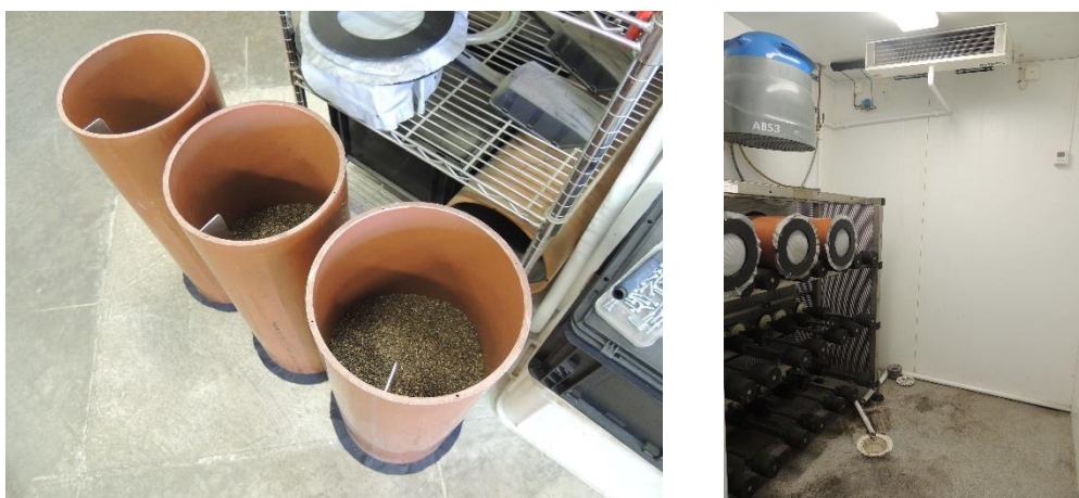
Obr. 3: Osivo ve válcích připravené k dovlhčení (vlevo), válce na otáčecích policích v inkubátoru v průběhu dovlhčení (vpravo)
