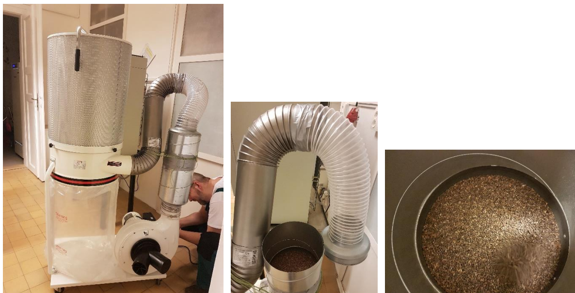
Obr. 9: Sušárna pro sušení osiva (vlevo) v sušícím bubnu (uprostřed) s osivem (vpravo)
