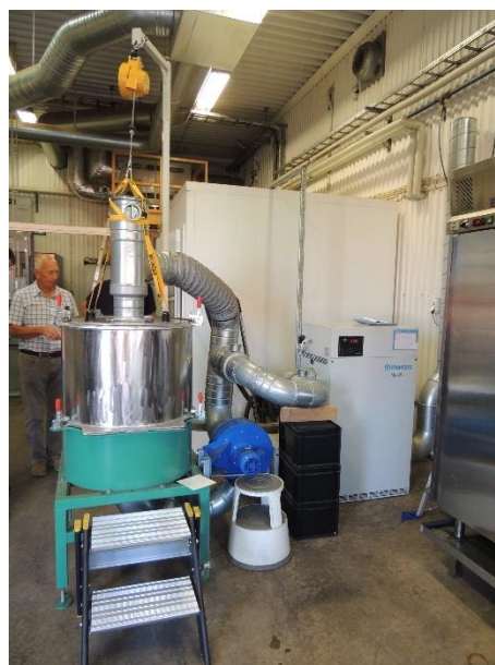
Obr. 5: Osivo v průběhu sušení v sušícím bubnu (vlevo), vybavení k sušení osiva se sušícím bubnem (vpravo)
