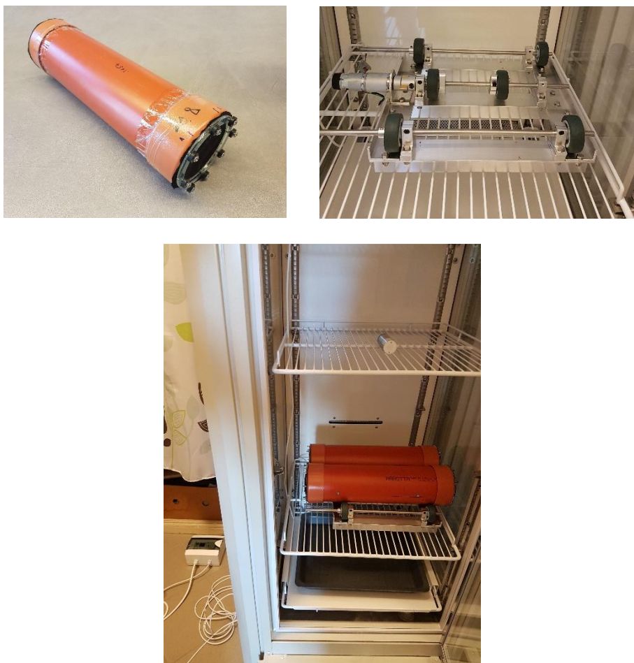
Obr. 7: Válec pro dovlhčení osiva (nahore vlevo), otáčecí polička (nahore vpravo), inkubátor s válci na otáčecí poličce připravený k dovlhčení osiva (dole)
