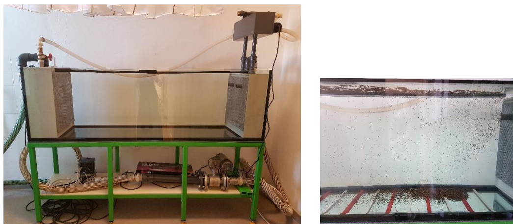
Obr. 12: Plavící komora (vlevo), plavení osiva v průběhu separace v rámci metody IDS (vpravo)
