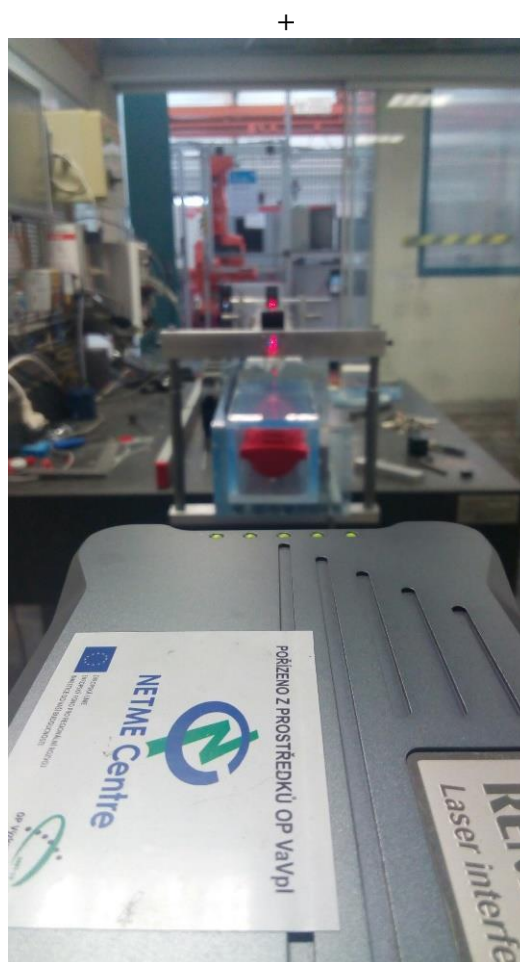
Obr. 5 Sestava laserového interferometru XL-80
