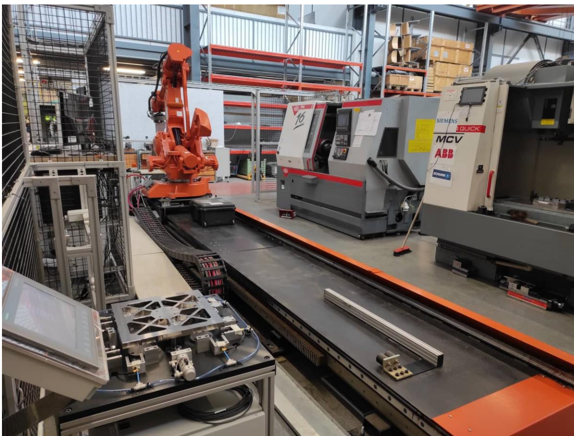
Obr. 16 Jednoučelová měřicí stanice v kontextu výrobní buňky ústavu Výrobních strojů, systémů a robotiky
