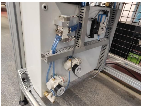
Obr. 14 Detail pneumatického obvodu
