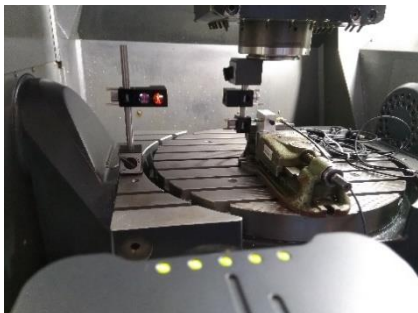
Obr. 9 Optika laserového interferometru XL-80 pro kalibraci snímačů
