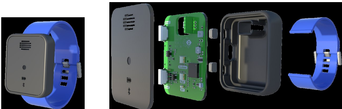
Obrázek 3: Nositelný senzor míry perspirace – Zleva: Vizualizace složeného náramku; Rozložený pohled na chytrý náramek se senzorem perspirace.
