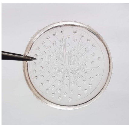
Obrázek 3: Mikrofluidní kolektor potu vyrobený z PDMS
