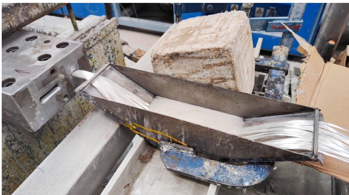
obr. 2 průchod vláken impregnační lázni (vanička s pryskyřicí)
