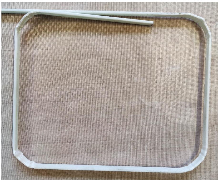
obr. 5 funkční vzorek dodatečně ohýbané termoplastické výztuže
