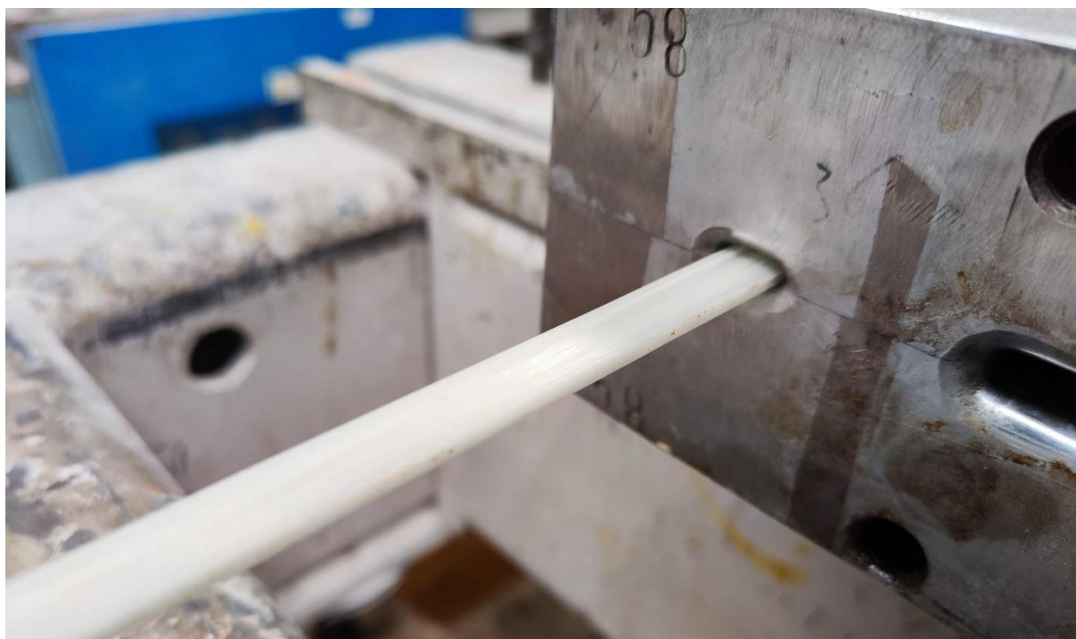
obr. 4 výstup produktu z formy
