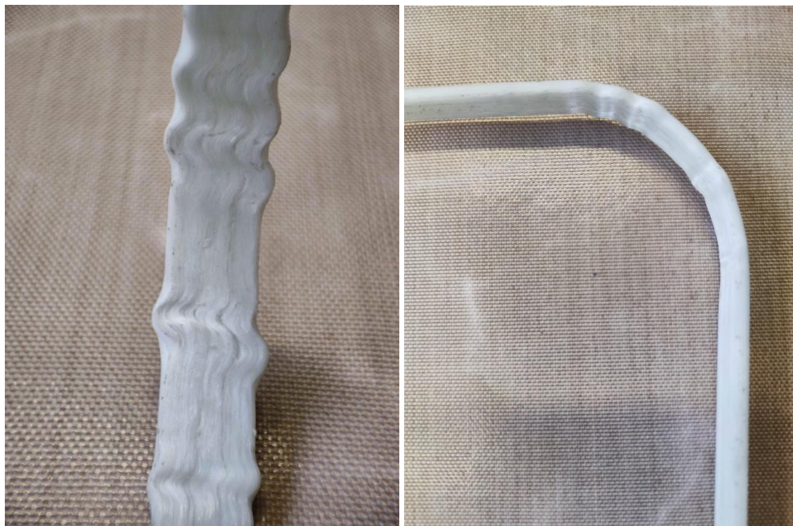
obr. 6 funkční vzorek ohýbané termoplastické výztuže – detail ohybu
