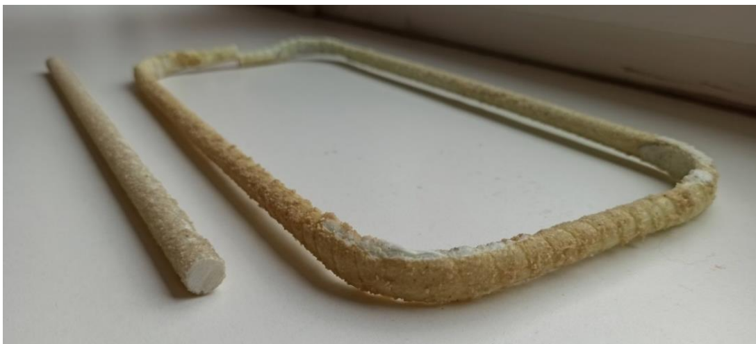
Obr. 4 Kompozitní FRP výztuž v provedení přímé a nepřímé výztuže
