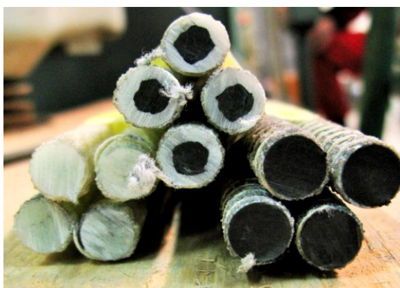
Obr. 1 Průřez vybranými typy FRP výztuží (zleva GFRP, C-GFRP a CFRP)
