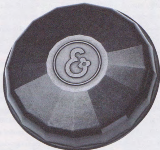
Bakelit, první průmyslově vyráběný polymer, se před nástupem termoplastů uplatňoval při výrobě krabiček, kelímků a víček. Protože výlisky slabě páchly po fenolu, nepoužívaly se k balení potravin. Bakelitový kelímek na pěnivý holicí krém Elida; padesátá léta.
