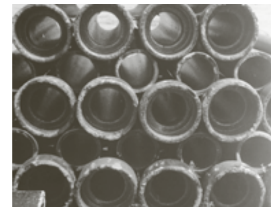
SKLÁDKA KANALIZAČNÍCH TRUB [72]
