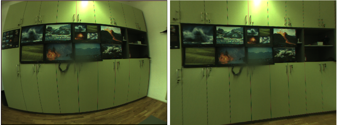
Obrázek 4.15: Na levém obrázku je nezkalibrovaný obraz z kamery. Na pravém obrázku je obraz už zkalibrovaný. Vidíme, že soudkovité zkreslení je odstraněno, ale přišli jsme tím o část obrazu. Pokud tak zkalibrujeme stereokamery, přijdeme o část obrazu, kterou vidí levá i pravá kamera zároveň. Slepý bod se nám tak posune dále od kamer.
