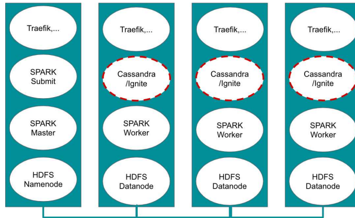
Obrázek 2: Logická struktura clusteru založeném na Kubernetes.
