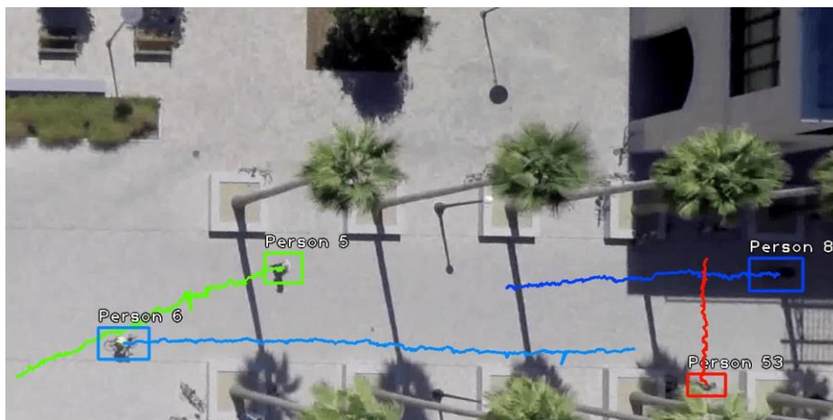
Obrázek 22: Vizualizace trajektorií chodců třetí verzí algoritmu. Nyní jsou ve snímku vyznačeni pouze pohyblivé objekty a směr jejich pohybu.
