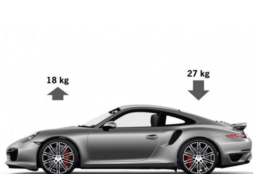
Obr. 3 Vztlak při rychlosti 300 km/h pro Porsche 997 a 991 v režimu Performance [8]
