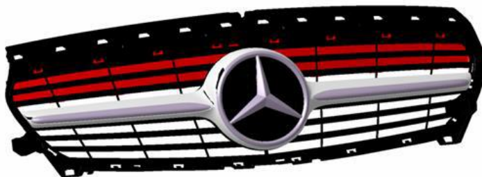
Obr. 14 Přední mřížka vozu, červeně zvýrazněné jsou regulační klapky [8]
