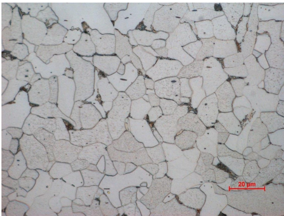
Obr. 4.0.1. Mikroštruktúra základného materiálu S235JR tvorený Ferritom a Perlitom
