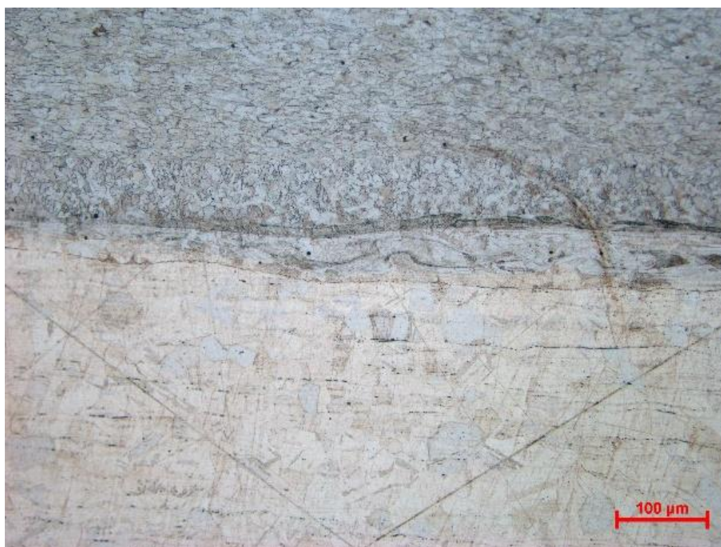
Obr. 4.32.2. Turbulentné premiešanie a malá TOO
