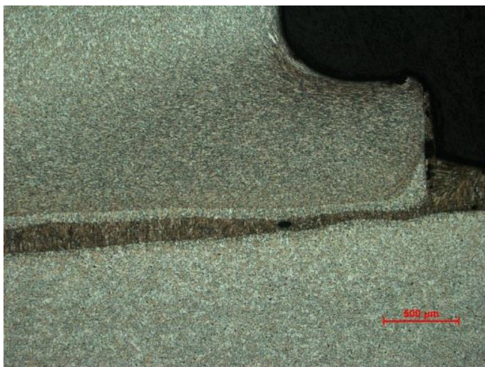
Obr. 4.10. Mikroštruktúra v oblasti zvaru – viditeľný základní materiál, TOO a zvarový kov s usmernenou mikroštruktúrou
