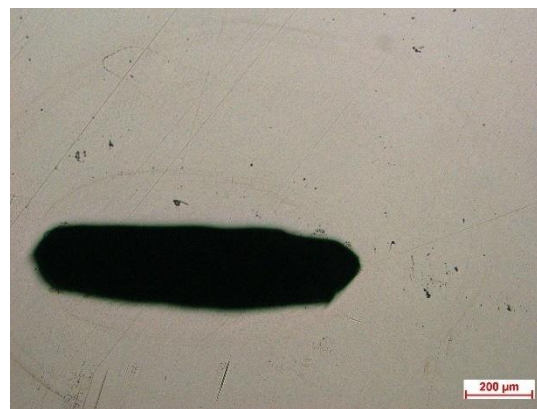
Obr. 4.6. Nenaleptaný stav - mierny defekt
