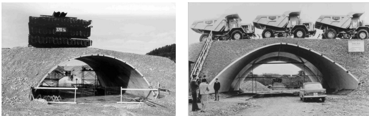
Obr. 6.8 Zatěžovací zkoušky prototypů systému BEBO ve Švýcarsku, tloušťka železobetonové klenby je 160 mm, při zatěžovací zkoušce vlevo bylo aplikováno zatížení 370 t – (BEBO, 2013).
