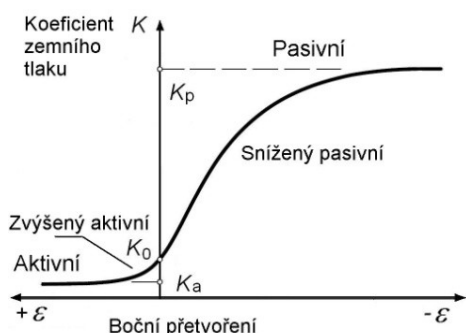
Obr. 6.1 Vztah mezi bočním přetvořením a koeficientem zemního tlaku.
