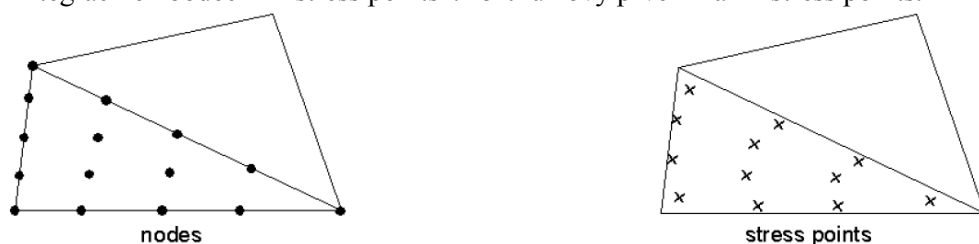
Obr. A.12 Element se znázorněním uzlů a integračních bodů (Brinkgreve, et al., 2008).
