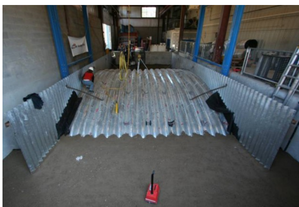
Obr. 6.9 Výstavba klenby a osazení extenzometrů (Mak, et al., 2009).
