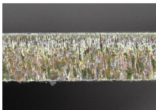
Obr. 41 Rezná hrana vzorku č. 16
