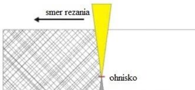
Obr. 16 Poloha ohniska pri tavnom laserovom rezaní [25]
