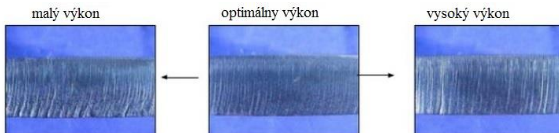
Obr.19 Vplyv výkonu laseru na kvalitu rezných hrán [26]
