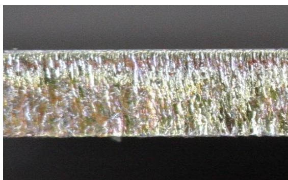
Obr. 42 Rezná hrana vzorku č. 11
