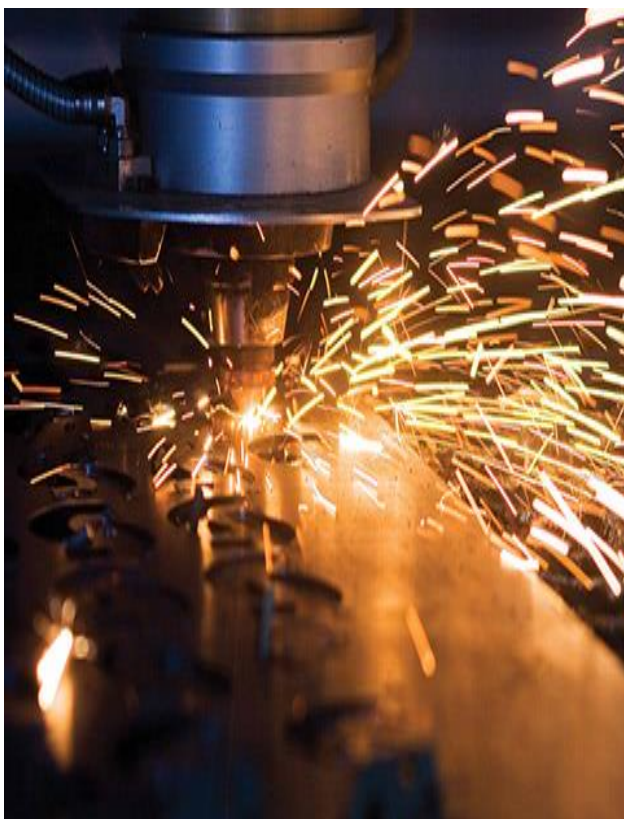
Obr. 1 Ukážka laserového rezania a laserovej procesnej hlavy [21], [33]
