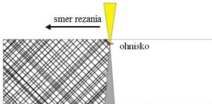
Obr. 17 Poloha ohniska pri oxidačnom rezaní [25]
