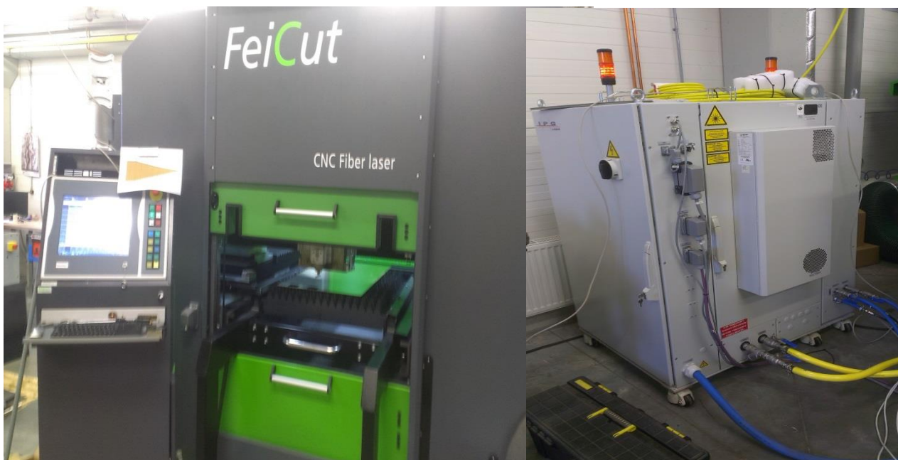
Obr. 32 Zariadenie FLC 0800 a laser YLS 5000
