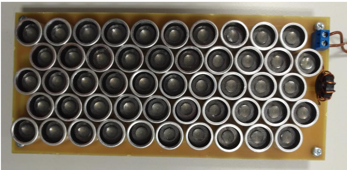
Obr. 3.10: Pole PZT měničů o rezonanční frekvenci 40 kHz
