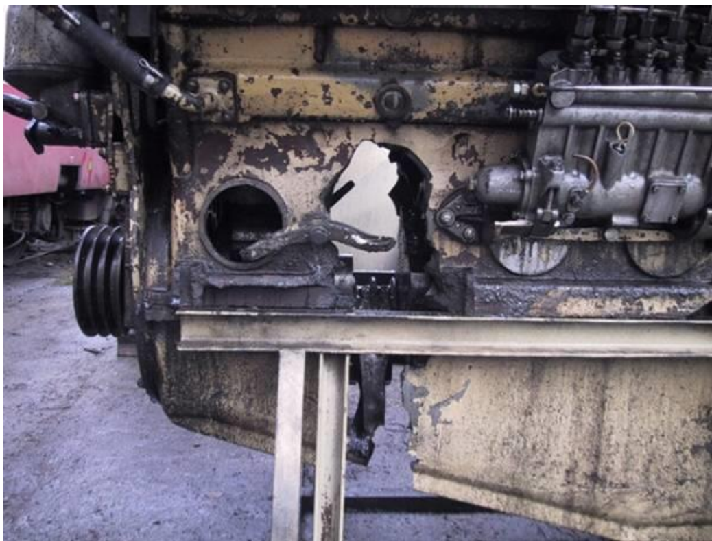
Obr. 21 Havárie motoru KS 12 V 170 DR [12]
