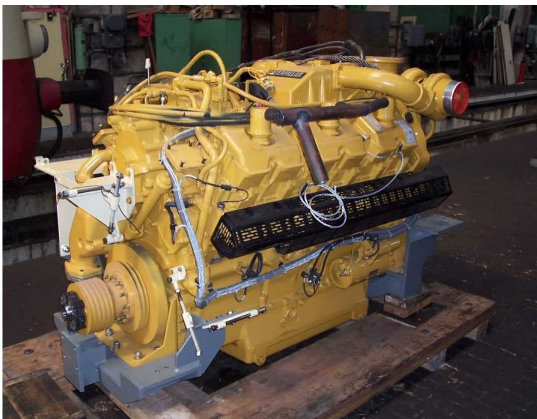
Obr. 27 Motor Caterpillar 3412 E DI-TA připravený k zástavbě do motorového vozu řady 854 [13]
