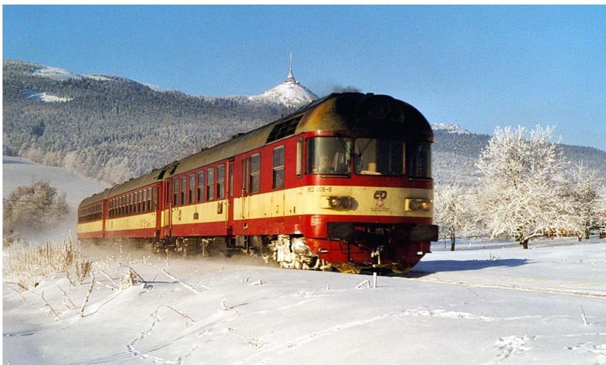
Obr. 16 Motorový vůz řady 852.006 osazený motorem KS 12 V 170 DR [6]
