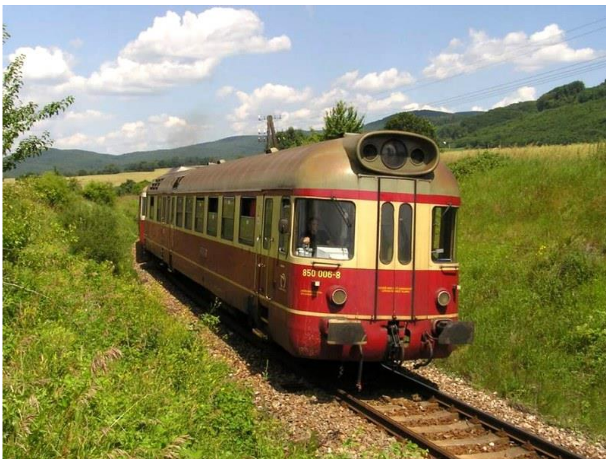
Obr. 20 Motorový vůz typu 850.006 osazený motorem čtvrté série K 12 V 170 DR [5]
